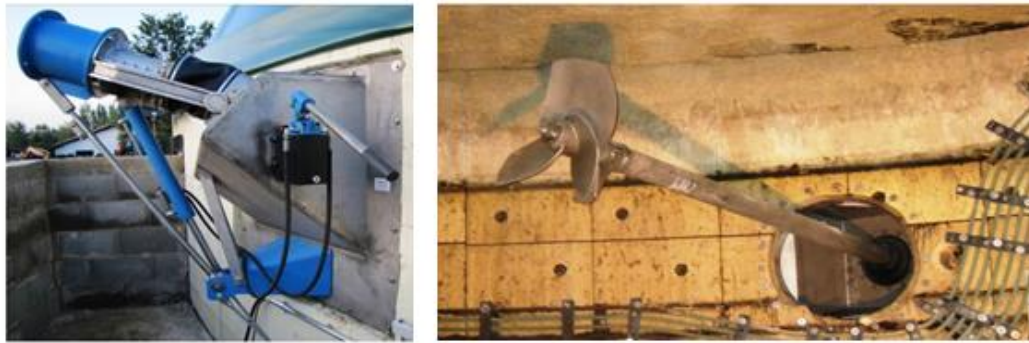
Abbildung 7.11: Stabrührwerk, Bay. LfL. 2014
