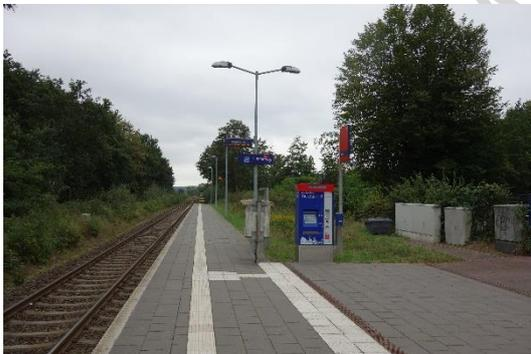
Abbildung 41: Taktile Elemente am Bahngleis
